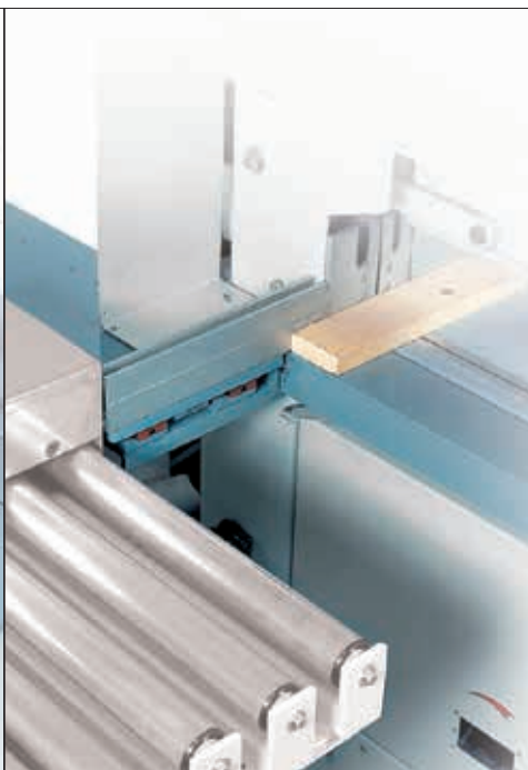
Trampilla de expulsión de los recortes de extremidades iniciales y finales de cortes rectos (abierta)
